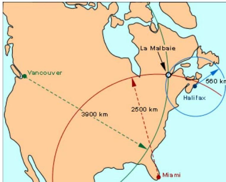
fig. n°7.11- Détermination de l'épicentre à partir de 3 sismographes
